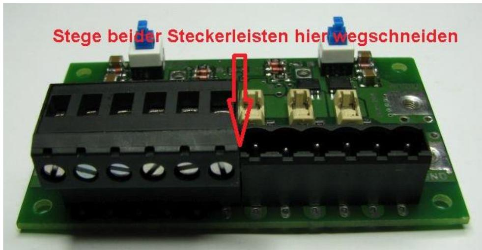
Für die beiden WAGO Klemmleisten mit 2 Lötstiften gibt es zum Öffnen das Werkzeug WAGO236-332. Hier ist eine Verlötlung beider Lötstifte je Klemme zu empfehlen, da die Federkraft der Klemmen und damit die Kraft, die zum Öffnen notwendig ist, recht hoch ist.
