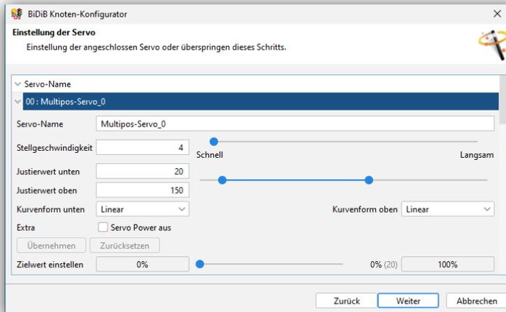
Alle Parameter, z.B. Geschwindigkeit, Startposition, Endposition, Servo Power abschalten nach Bewegung und Kurvenform des Servos, können vom PC verändert werden.
